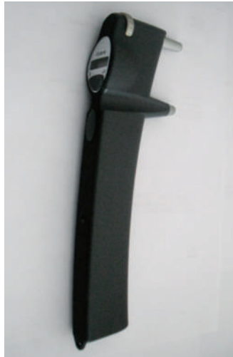
Figura 2. Tonómetro de rebote ICare®.
